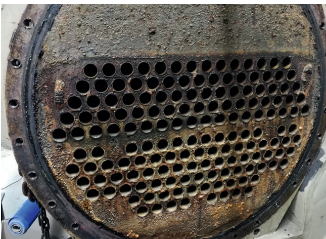
Organische afzetting in een warmtewisselaar (biofouling)
