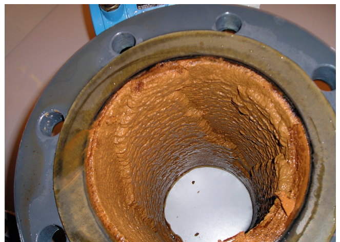
Anorganische afzetting in een flowmeter (scaling)
